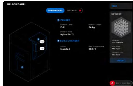
**2. Finalización del proceso de enfriado en la Fuse Sift:** tras completar el enfriado inicial en la Fuse 1, es necesario transferir la cámara de impresión a la Fuse Sift. Conecta la cámara de impresión a la Fuse Sift para monitorizar la temperatura y recibe una notificación cuando las impresiones estén listas para su extracción.
