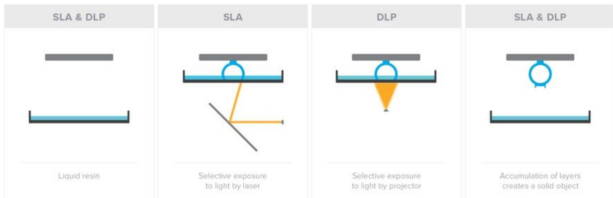
La tecnología SLA utiliza dos motores, conocidos como galvanómetros (uno en el eje X y el otro en el eje Y) para apuntar rápidamente un rayo láser a través del área de impresión, solidificando la resina a medida que avanza. Este proceso desglosa el diseño, capa por capa, en una serie de puntos y líneas que se le comunica a los galvanómetros como un conjunto de coordenadas.
