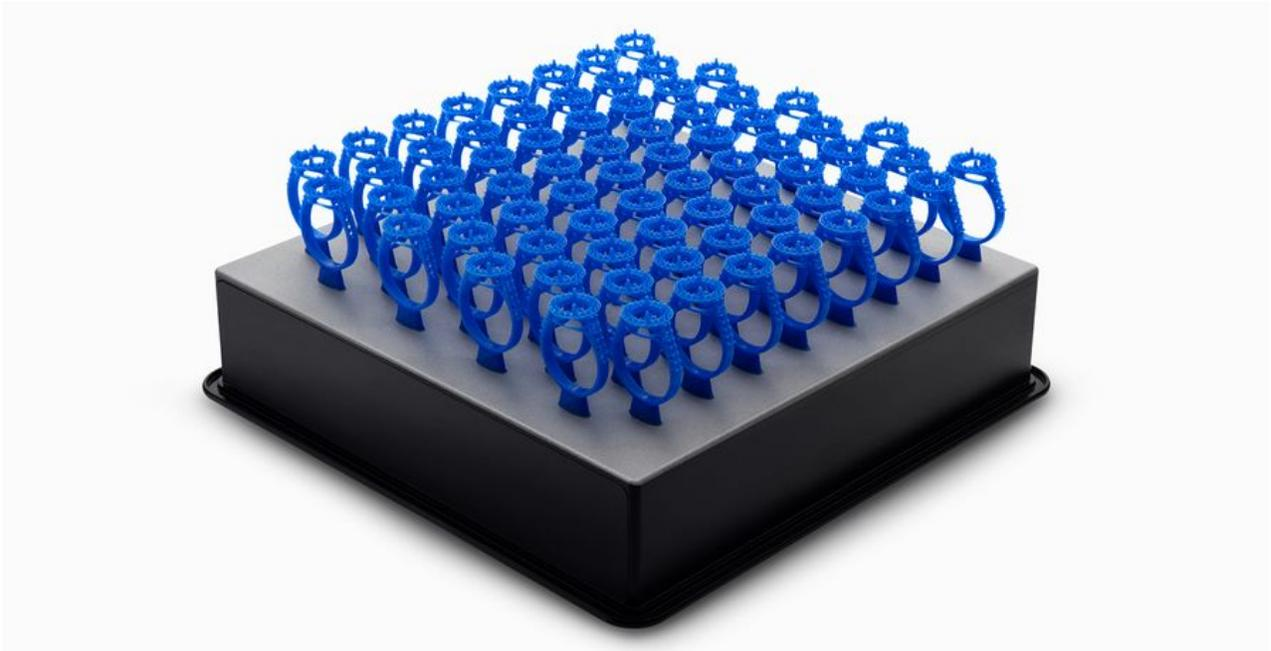
Las impresoras 3D de DLP no pueden imprimir piezas de alta resolución que llenen una gran parte del volumen de construcción. Por ejemplo, una impresora DLP es capaz de imprimir bien un anillo detallado, y más rápidamente que una impresora de SLA. Sin embargo, la impresión de muchos anillos detallados a la vez requeriría una impresora 3D de SLA, capaz de realizar una alta resolución consistente en todo el volumen de construcción.
