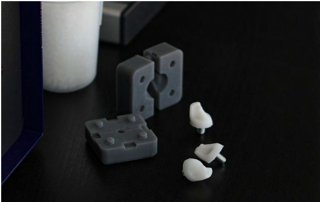
Tacos de fútbol inyectados en la Holipress con moldes impresos mediante la Grey Pro Resin.
