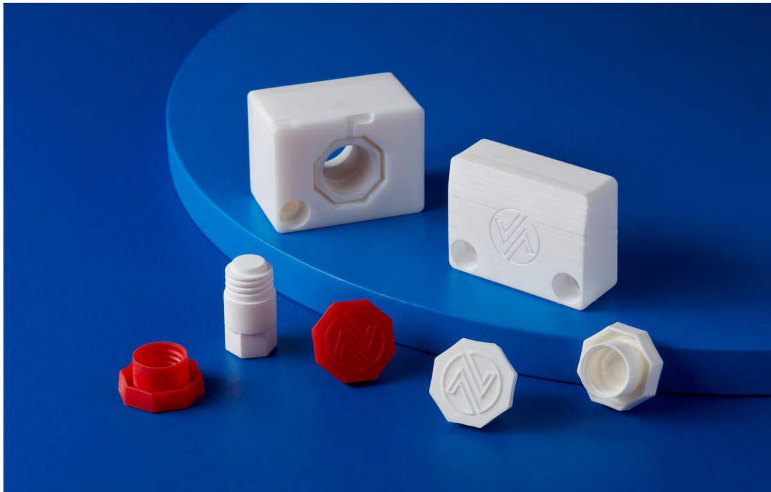
El molde de tres piezas impreso con las tapas inyectadas en polietileno.
