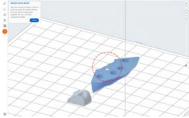
Para girar 180 grados la pieza fácilmente, pasa el cursor por encima de los botones de Orient To Bounding Box (Orientar respecto al cuadro delimitador) dentro de la herramienta Orientation (Orientación). Selecciona el botón que girará la pieza de forma que la superficie oclusal esté orientada hacia la base de impresión.
