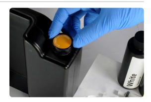
1.3 Extrae 40 ml de la resina del cartucho de Flexible 80A Resin utilizando un vaso o recipiente de vidrio y una de las jeringas de 10 ml suministradas.
