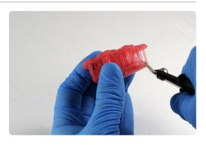
Como segundo paso, se pueden utilizar unas tijeras pequeñas y afiladas para cortar los soportes más cerca de la pieza.
