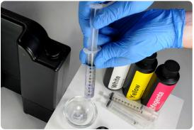
1.4 Para utilizar las jeringas con diferentes resinas o pigmentos, saca el émbolo del cuerpo de la jeringa y enjuágala con alcohol isopropílico limpio. Repite la operación si es necesario.
