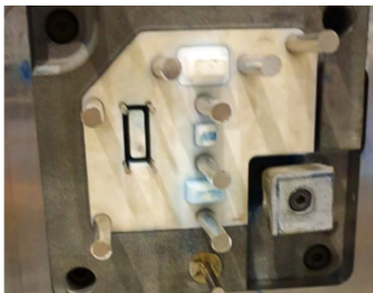
Molde impreso con la Rigid 10K Resin ensamblado en el troquel de metal. Lado móvil con pernos de eyección, insertos y armazón de SLS (izquierda) y lado estático (derecha).
