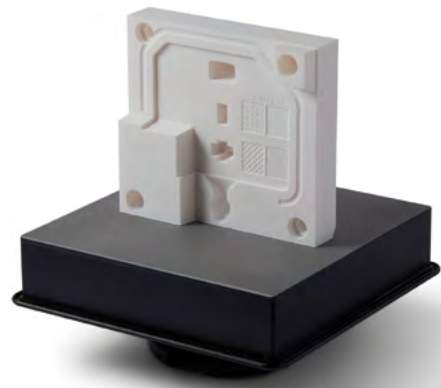
Molde impreso con la Rigid 10K Resin, con el lado estático sobre la base de impresión.
