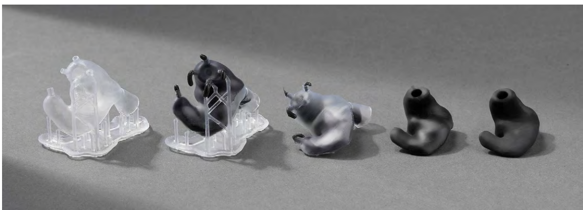
El proceso paso a paso de crear almohadillas a medida para el oído utilizando moldes auriculares de silicona.
