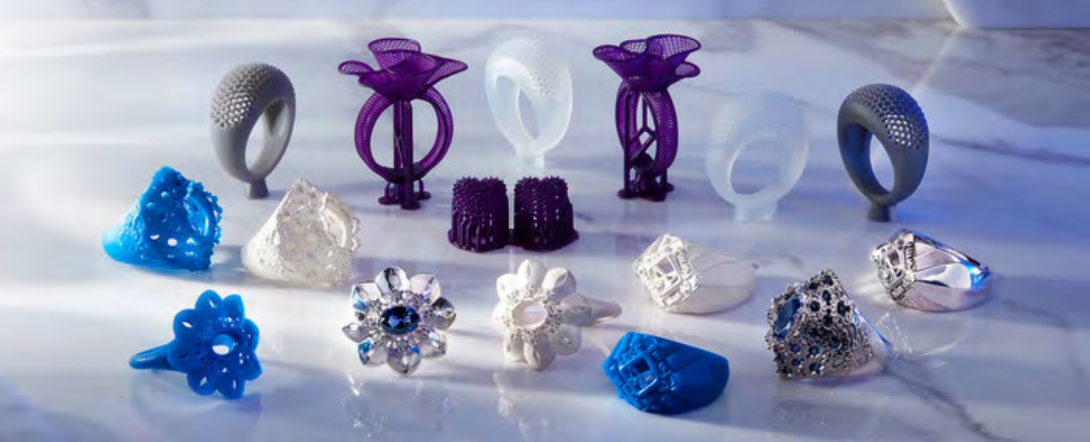
Patrones de joyería impresos en 3D y anillos fundidos con metales preciosos.
