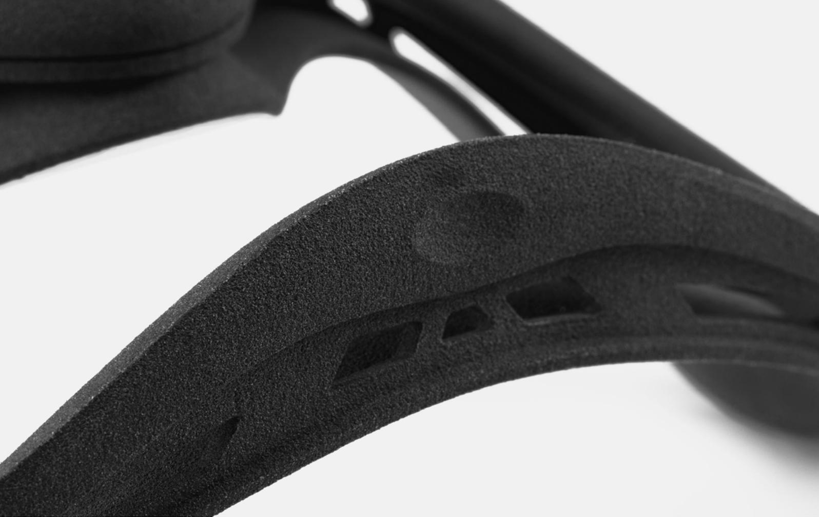
*Las piezas realizadas mediante SLS tienen un acabado de la superficie ligeramente granuloso, pero casi no tienen líneas de capa visibles. Se recomienda someter las piezas de SLS a un granallado o pulido para obtener un acabado de la superficie más liso. Esta pieza de ejemplo se ha imprimido en una impresora 3D SLS industrial de trabajo Fuse 1 de Formlabs.*
