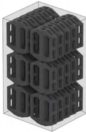
*La impresión SLS permite que los operarios coloquen la mayor cantidad de piezas posible en la cámara de impresión y que las impriman sin soportes para ahorrar tiempo de posacabado.*
