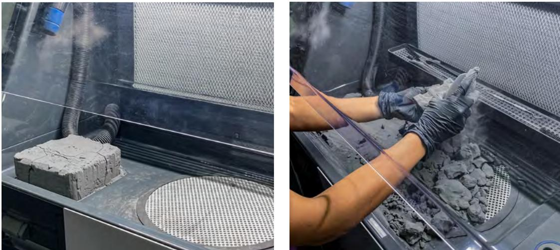
La Fuse Sift completa el proceso de trabajo de SLS de la Fuse 1. Ofrece un sistema seguro y eficiente para extraer las piezas y reciclar el polvo. La Fuse Sift puede dosificar y mezclar el polvo usado y el polvo nuevo de manera automática para que puedas reducir los residuos y controlar tu suministro de polvo.
