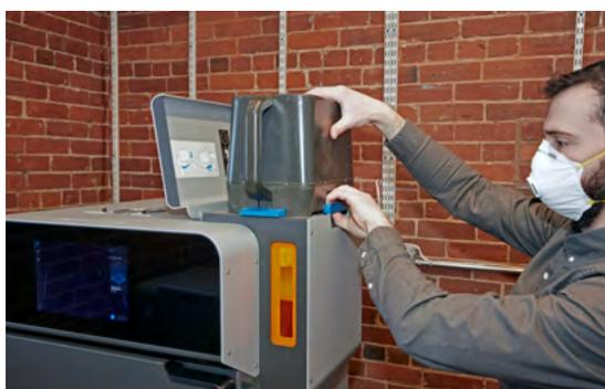
En la Fuse 1, el polvo puede cargarse fácilmente mediante el cartucho de polvo.
