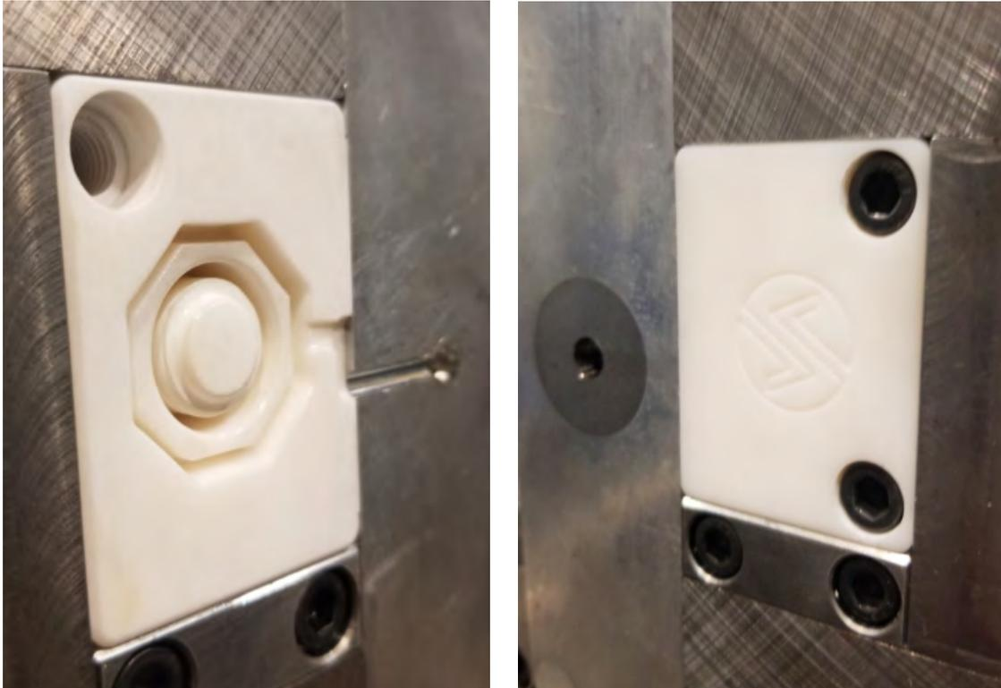
Los moldes impresos se colocaron en un armazón metálico antes de la inyección. El macho con movimiento lateral se introdujo en la cara B (izquierda), que se bloqueó con la cara A estática (derecha).
