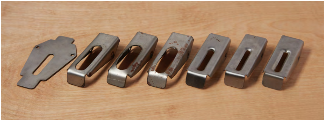
Diversas iteraciones de la parte superior del protector de cuchilla.
