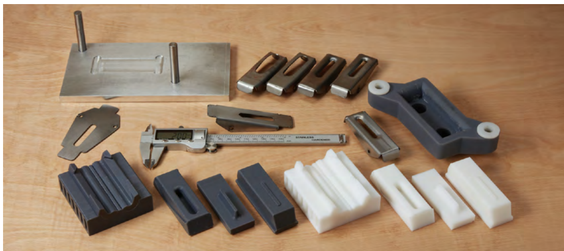
Troqueles impresos e iteraciones de las piezas metálicas para conformar el protector de cuchilla.
