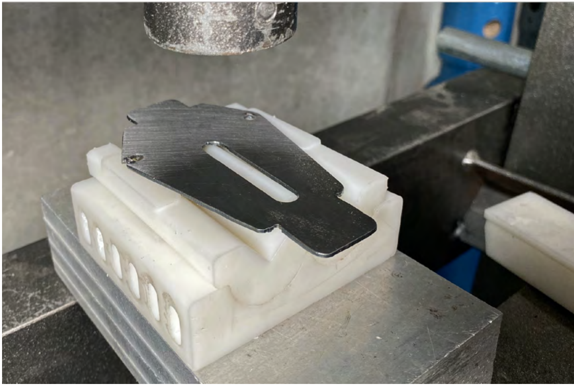
La operación de prensado para doblar los rebordes.
