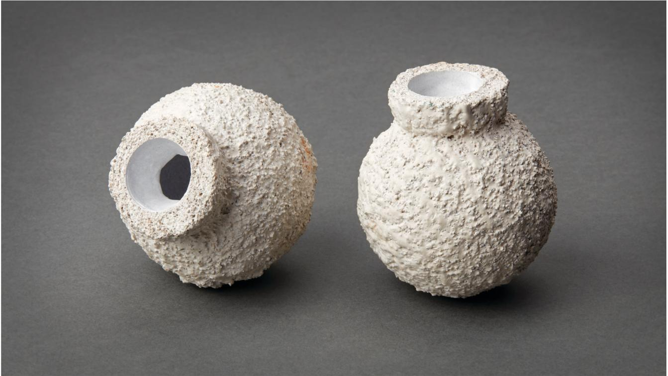
*Cáscara cerámica tras el quemado de modelos impresos mediante SLA con Clear Resin.*
