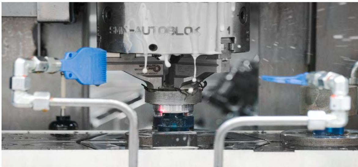
*Al ser isotrópicas, piezas impresas mediante SLA como este [dispositivo de sujeción de Pankl Racing Systems](#) pueden soportar las diversas fuerzas direccionales que sufren durante las operaciones de fabricación más exigentes.*
