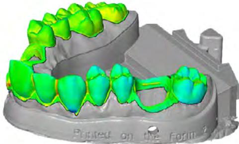
*Este ejemplo del sector de la odontología que compara un componente escaneado con la geometría original en un software de diseño asistido por ordenador (CAD) demuestra la capacidad de mantener una escasa tolerancia en toda una pieza impresa mediante SLA.*
