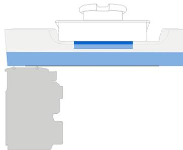
La impresión 3D LFS reduce drásticamente las fuerzas que soportan las piezas durante el proceso de impresión usando un tanque flexible e iluminación lineal, para ofrecer una calidad de superficie y una fiabilidad de impresión espectaculares. Descubre más sobre cómo funciona la LFS en [este vídeo de análisis profundo](#).
