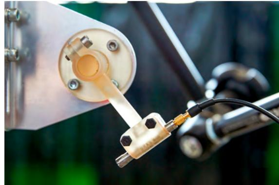
*Los ingenieros del AMRC [usan un parque de 12 impresoras 3D SLA](#) para imprimir piezas personalizadas para diversos proyectos de investigación, como piezas para un robot y soportes para sensores en un entorno a altas temperaturas (derecha).*
