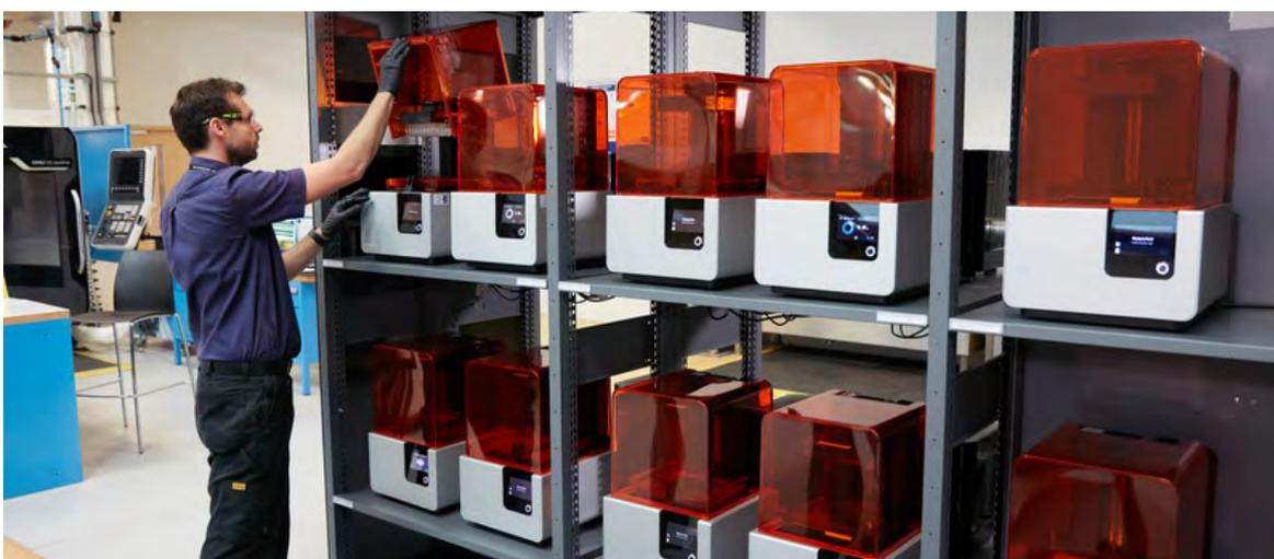
*El grupo de diseño y creación de prototipos del Centro de Investigación de la Fabricación Avanzada (AMRC) de la universidad de Sheffield mantiene un puesto de fabricación aditiva de libre acceso con [un parque de 12 impresoras 3D de estereolitografía \(SLA\) Form 2](#) para los cientos de ingenieros que trabajan en diversos proyectos en sus instalaciones.*
