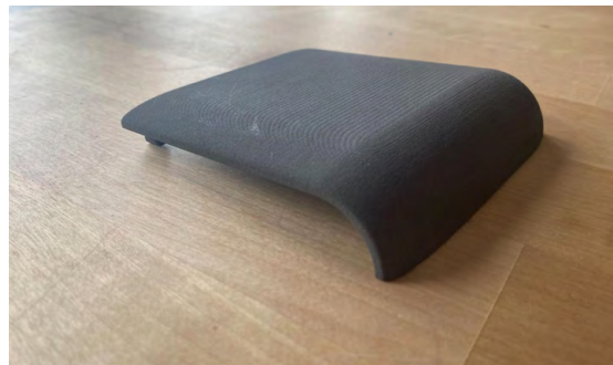
El molde impreso en la Fuse 1 para verter silicona
